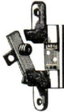
Figura 19 PRIMITIVO SECCIONADOR UNIPOLAR DE ALTA TENSION
